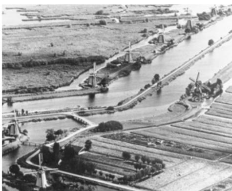
Figura 1.5: Molinos de viento en Holanda, para el drenado de tierras.
