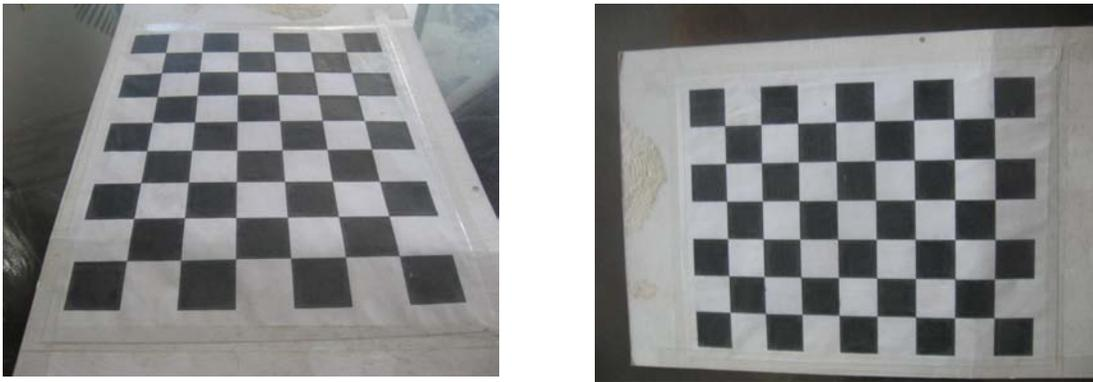
**Figura 13.** Aquí se muestra el patrón para calibrar en el método de Zhang, con diferentes orientaciones y traslaciones para una mejor aproximación.
