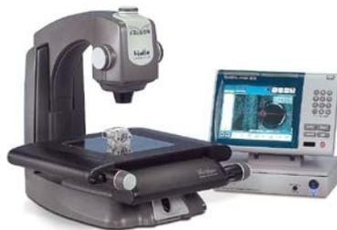
**Figura 23.** Sistema de control de calidad automático, trabaja por visión, compara las dimensiones de la pieza a revisar con la pieza modelo.
