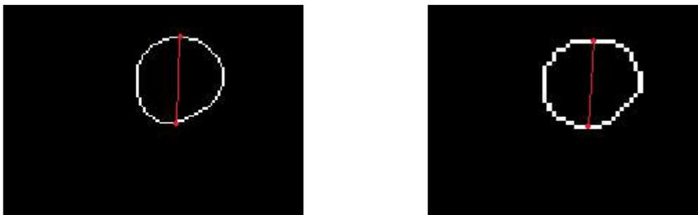
**Figura 6.** Se detecta el punto superior de la esfera y el punto inferior de la misma para medir su diámetro.
