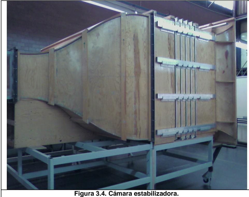
Figura 3.4. Cámara estabilizadora.
