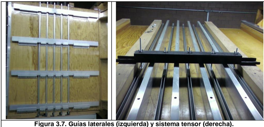
Figura 3.7. Guías laterales (izquierda) y sistema tensor (derecha).
