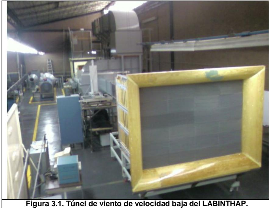
Figura 3.1. Túnel de viento de velocidad baja del LABINTHAP.
