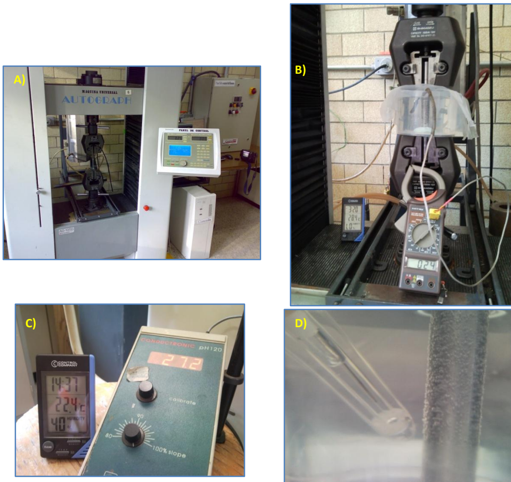
Figura 8. Equipo y sistema empleado para la realización de las pruebas en tensión. A) Vista general de maquina Universal Shimadzu. B) Modelo de prueba para medio acuoso "CD2" en operación, C) Hidrómetro y medidor de pH en una prueba normal con un medio y D) Vista interna del electrodo midiendo el pH en una prueba con solución ASTM G5 Solución acida 1N.
