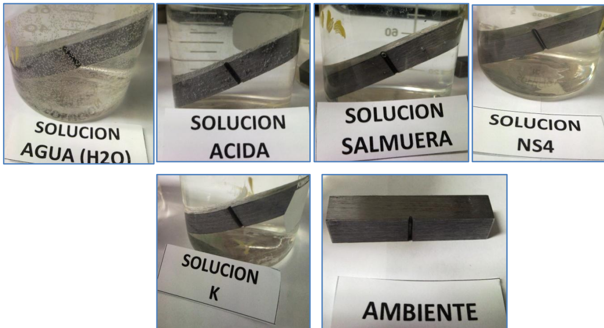
Figura 11. Acercamiento a detalle del comportamiento del medio acuoso sobre la probeta de impacto charpy a unos minutos de haber sido sumergida para su ensayo en impacto.
