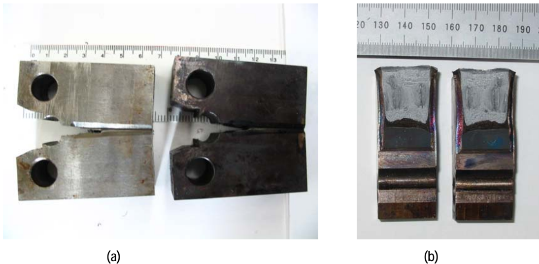
Figura 36. (a) Probeta compacta de tensión estándar con el teñido térmico previo a la fractura. (b) Probetas compactas de tensión estándar fracturadas .
