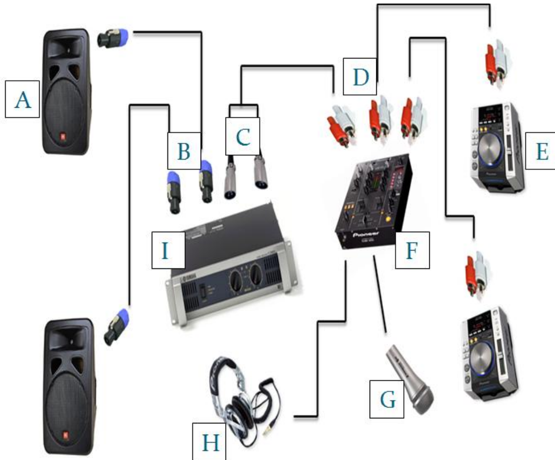
Figura 4.27 Diagrama de conexiones del sistema de audio.
