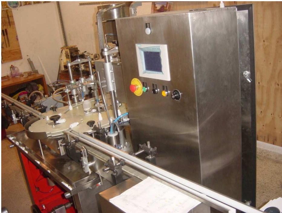
Figura 18.- Máquina circular llenadora de líquidos, luego de su remodelación. Mayo 2005, para Offenbach México.
