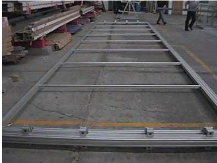
Figura 7.- Armado de puerta de seguridad para prensa Verson. Marzo 2002 para Chrysler Saltillo.
