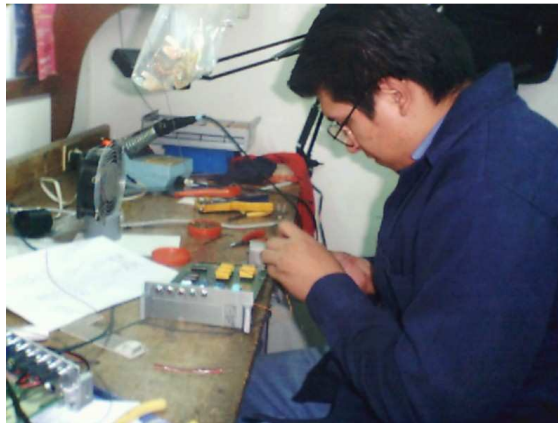
Figura 2.- Ensamble de tarjetas prototipo para equipos de prueba. Usado en el equipo “AudiCIM TST1”. Marzo de 2001. Para ATLINKS de México.
