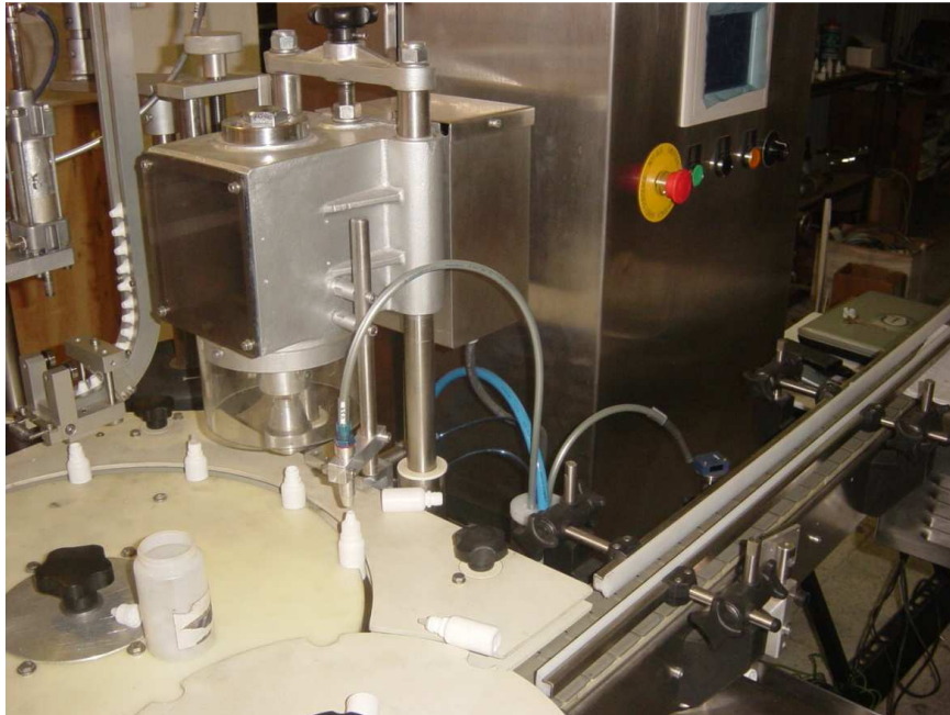
Figura 22.- Etapa de colocación de tapa, roscado y detección de tapa puesta de la máquina circular llenadora de líquidos, luego de su remodelación. Mayo 2005, para Offenbach México.
