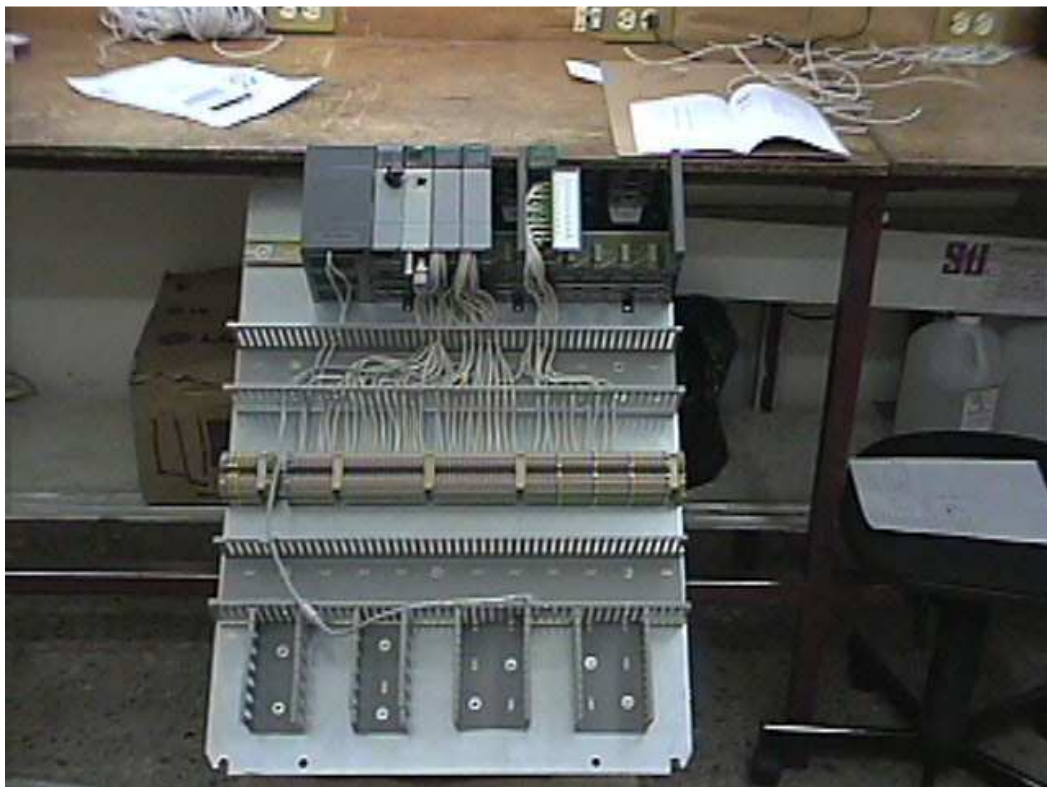
Figura 9.- Platina preliminar para pruebas de entradas y salidas con SLC500. Marzo 2002, Chrysler Toluca.
