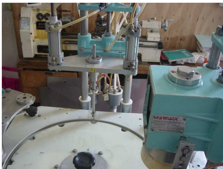
Figura 15.- Etapa de colocación de inserto y tapa para los frascos. Totalmente manual. Marzo 2005, para Offenbach México.
