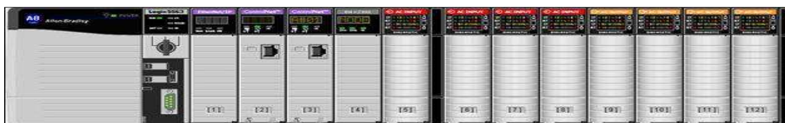
Figura 54.- Sistema ControlLogix con módulos de I/O y comunicación.
