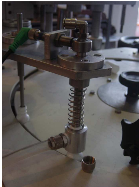
Figura 21.- Etapa de sopleado y detección de frasco y llenado de frasco de la máquina circular llenadora de líquidos, luego de su remodelación. Mayo 2005, para Offenbach México.
