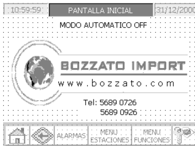
Figura 23.- Pantalla inicial de la máquina circular llenadora de líquidos, visualizada en el TP170. Mayo 2005, para Offenbach México.
