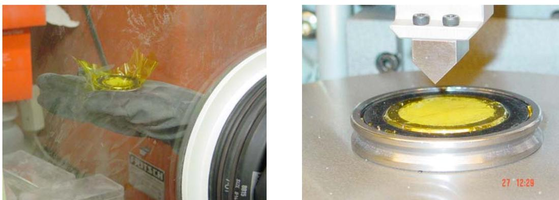
Figura 15. Portamuestras empleado para DRX de los aluminuros.
