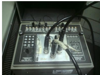
Figura 3.1 a) Analizador de Parámetros de Semiconductores HP; b) Conmutador; c) Máquina de puntas.
