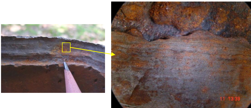
Figura 20.- Relieve con líneas onduladas y paralelas al eje longitudinal del tubo.
