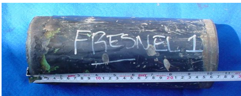
Figura 27.- Tramo de tubo del gasoducto fresnel de 3" D.N. en su condición como recibido.
