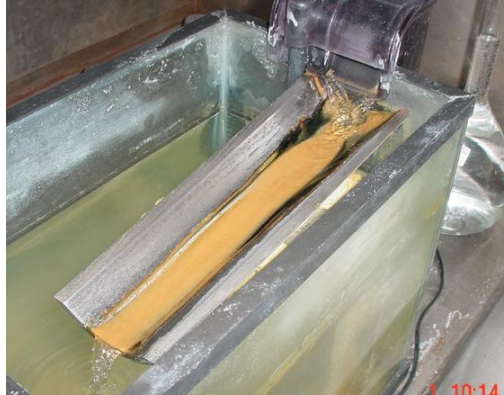
Figura 15.- Depósitos de productos de corrosión generados a 1 semana de exposición al medio acuoso.
