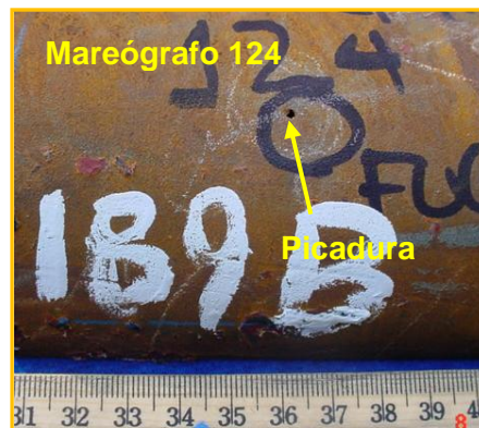
Figura 25.- Vista del gasoducto de 3"D.N. mareógrafo 124 en su condición como recibido.
