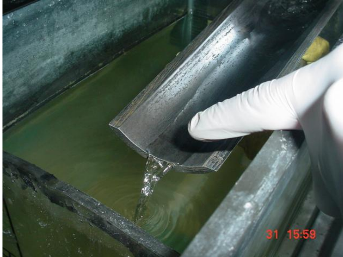
Figura 14.- Montado del modelo físico de la corrosión en medio acuoso, note el detalle de la caída de solución (medio acuoso).
