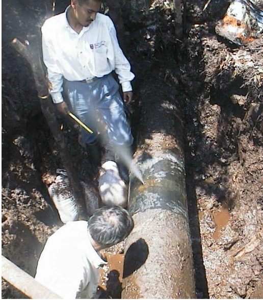
Figura 5.- Fugas en gasoductos por corrosión interna.
