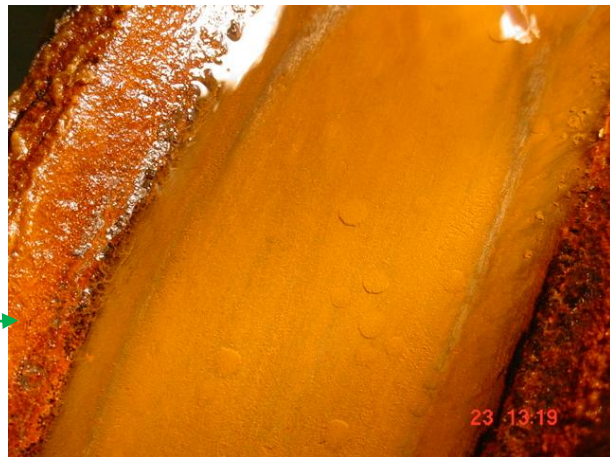
Figura 15.- Estado del tubo A, a los 20 días de exposición al medio acuoso, note la presencia de PM por corrosión.
