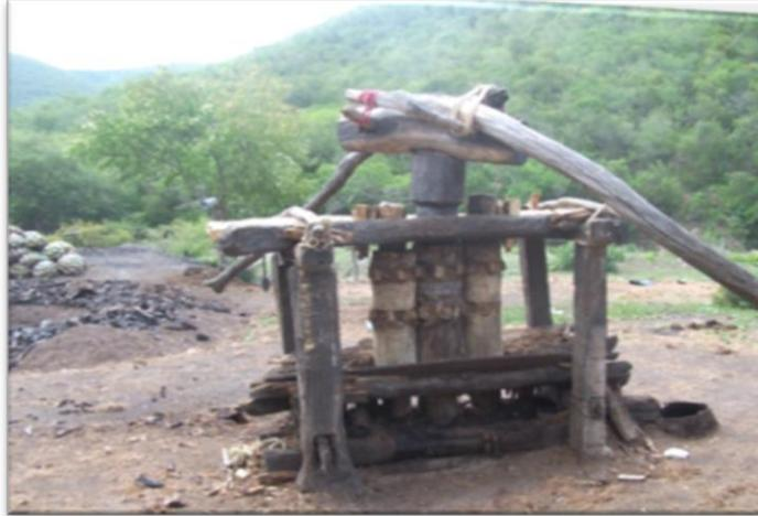
**Figura 6. Proceso de molienda de las piñas cocidas en un trapiche tradicional de madera, con tracción animal (Municipio de San Nicolás, Tamaulipas).**
